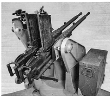
Спаренный крупнокалиберный пулемёт «Тип 93» на флотской тумбовой установке.
